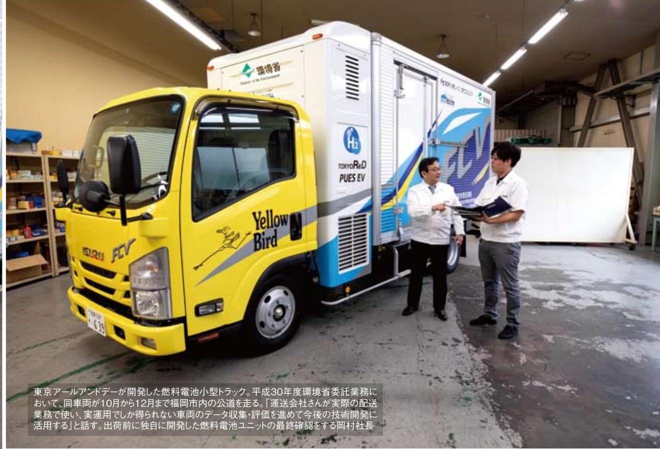
東京アールアンドデーが開発した燃料電池小型トラック。平成30年度環境省委託業務において、同車両が10月から12月まで福岡市内の公道を走る。「運送会社さんが実際の配送業務で使い、実運用でしか得られない車両のデータ収集・評価を進めて今後の技術開発に活用する」と話す。出荷前に独自に開発した燃料電池ユニットの最終確認をする岡村社長
