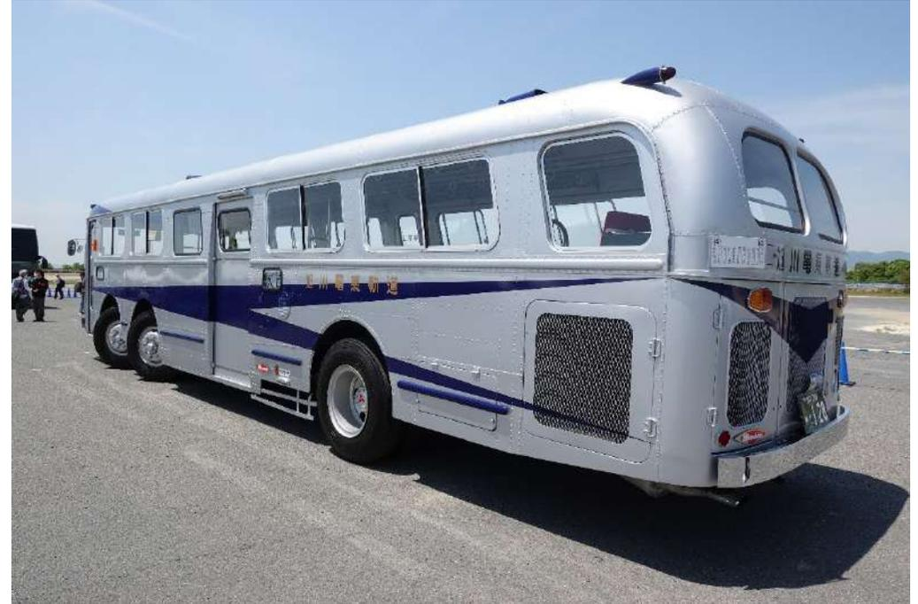
「MR430」は高度成長期に増加の一途をたどるバス需要に対して開発された全輪2軸構成をとる3軸のバス。1960年代前半に12台が製造された。全長12mの車体は110人もの乗員収容できるもの。「MR430」は、三菱ふそう製とはいえ、ボディ架装は複数社で製造された。今回の「旭川電気軌道」のものは、呉羽自動車工業製で3台製造されたうちの1台。その1台を今回「旭川電気軌道」が子会社とともにレストアしたもの。1978年に路線バスから引退し、所有者を転々とした43年後「旭川電気軌道」の手に渡り、この度1年3か月をかけてレストアされたもの。
