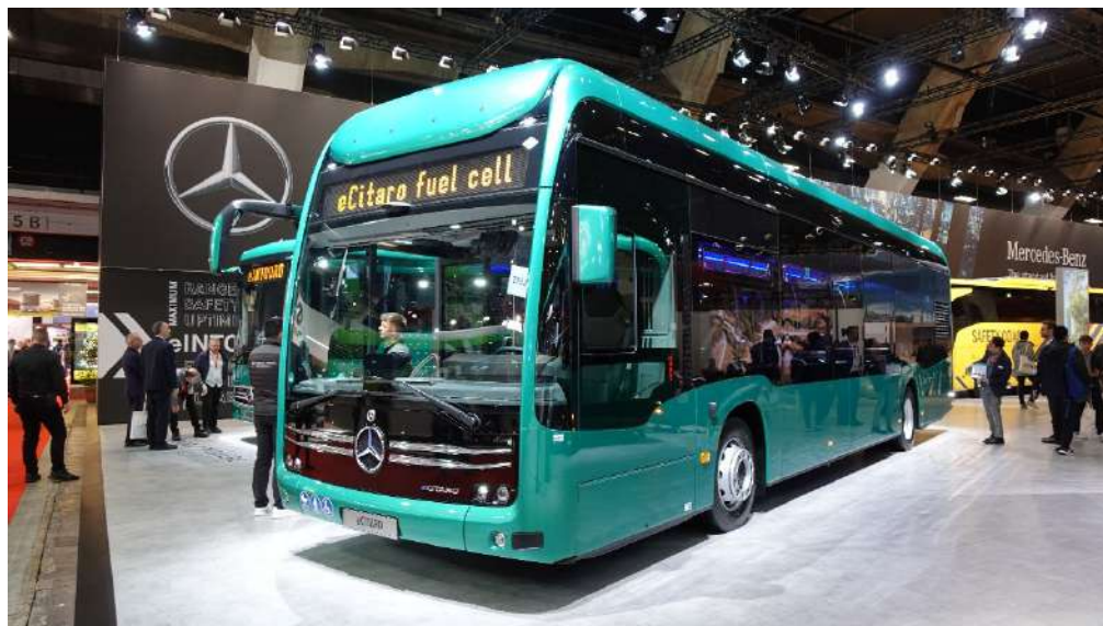
Citaro FUEL CELL(ドイツ)レンジエクステンダー トヨタ製60kWスタックを搭載
