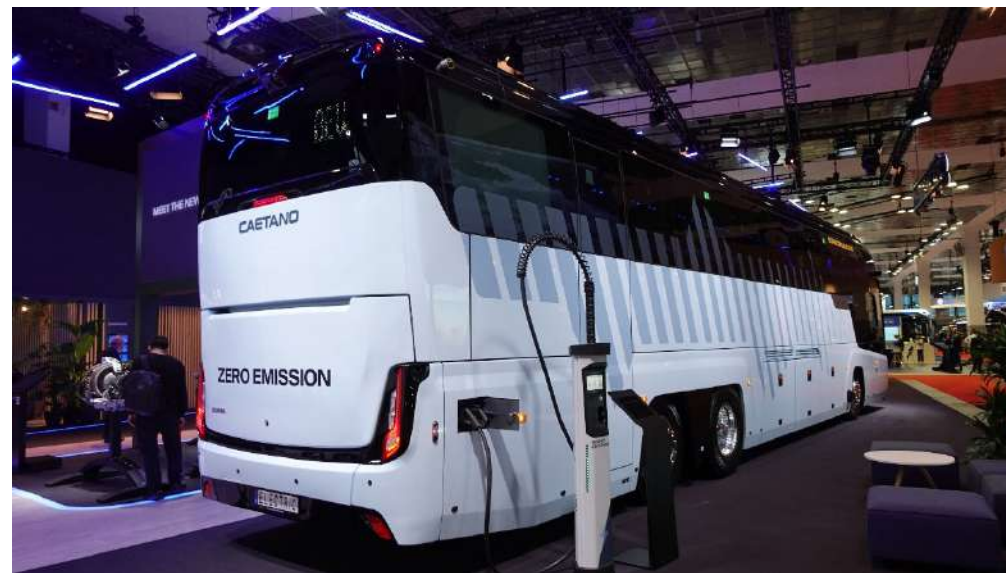
Irizar製とCAETANO製のインターシティEVバスを展示。445kWhと534kWhのバッテリーを搭載。
