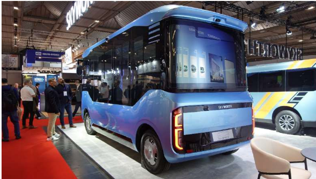
全長5.5mのミニバス。75と89kWhの2種類のバッテリー容量。
