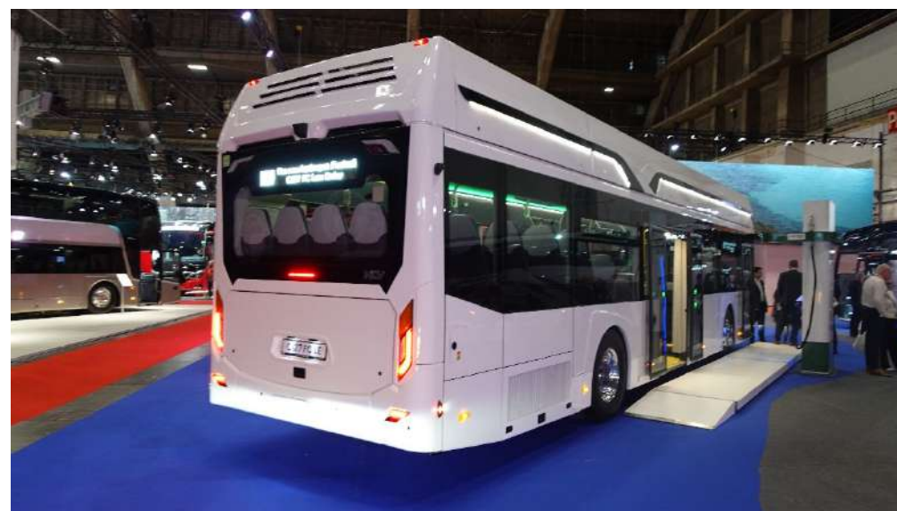
C127FC バラード製100kWを搭載
