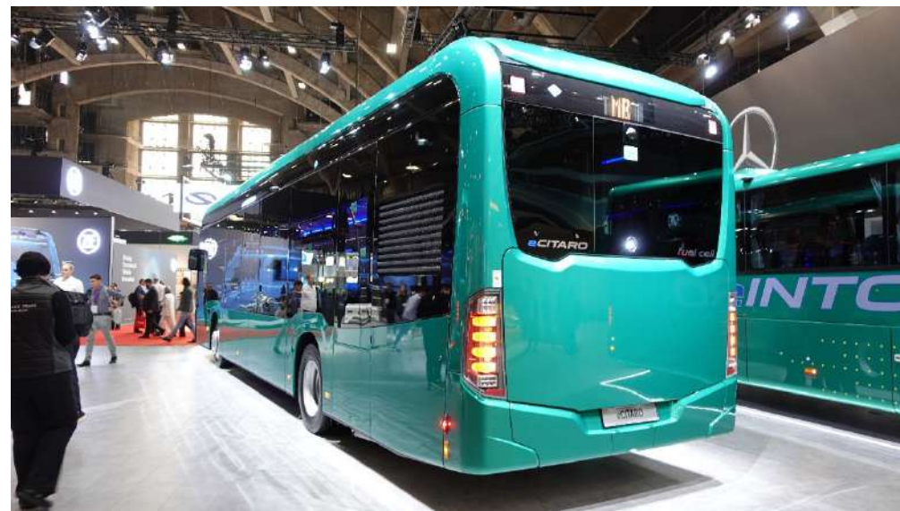
Citaro FUEL CELL(ドイツ)レンジエクステンダー トヨタ製60kWスタックを搭載
