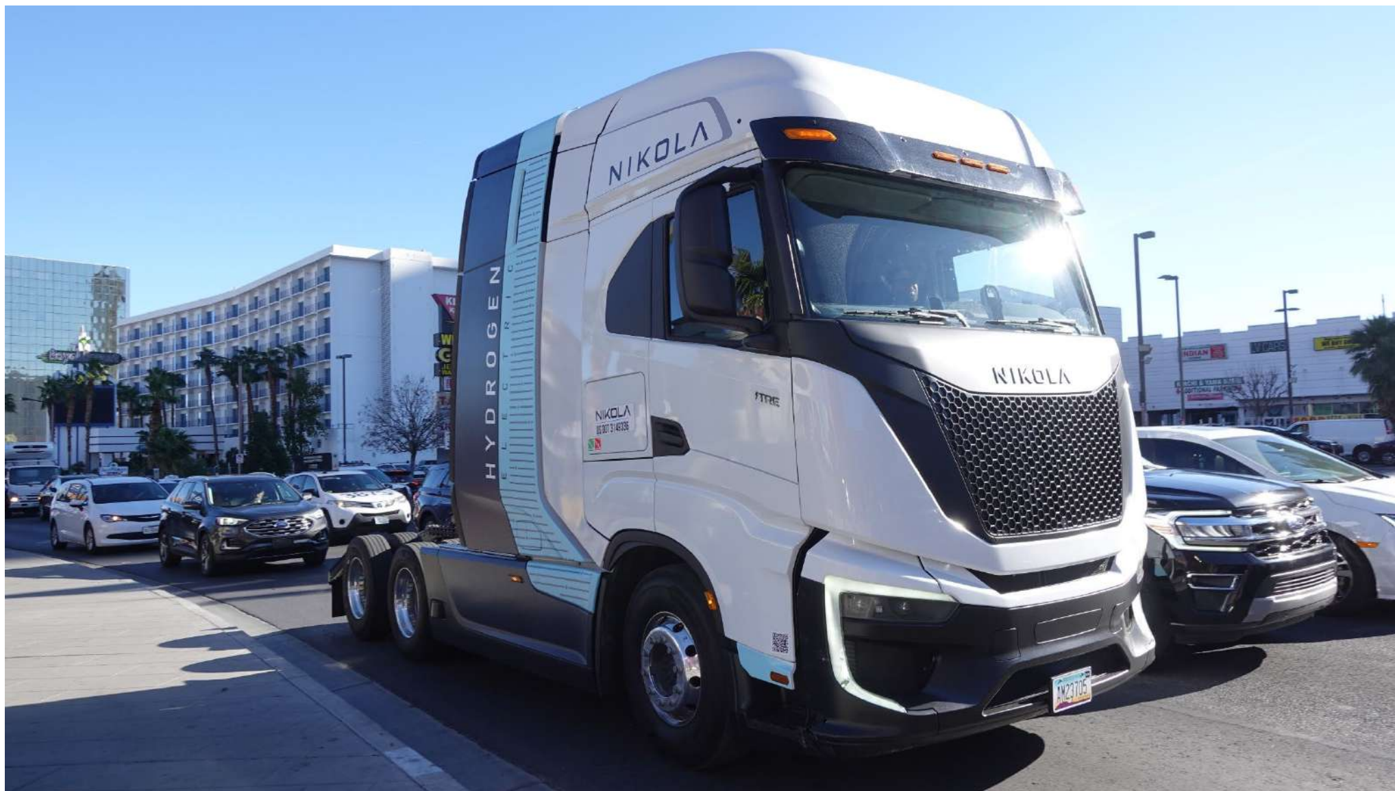
IVECOの車体をベースにFCEV化。会場外の公道をデモ走行していた
