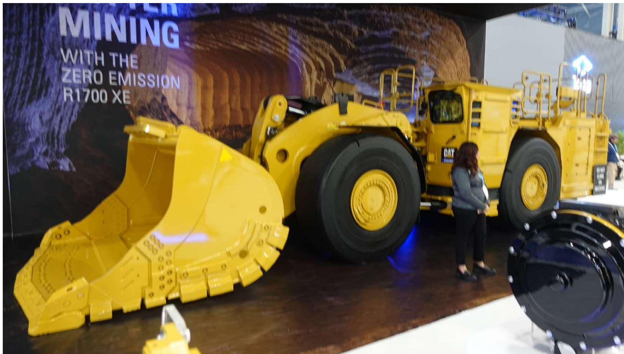
「R1700 XE」電動の坑内採掘用ロードホールダンプローダー。排ガスなし、静音等が特徴
