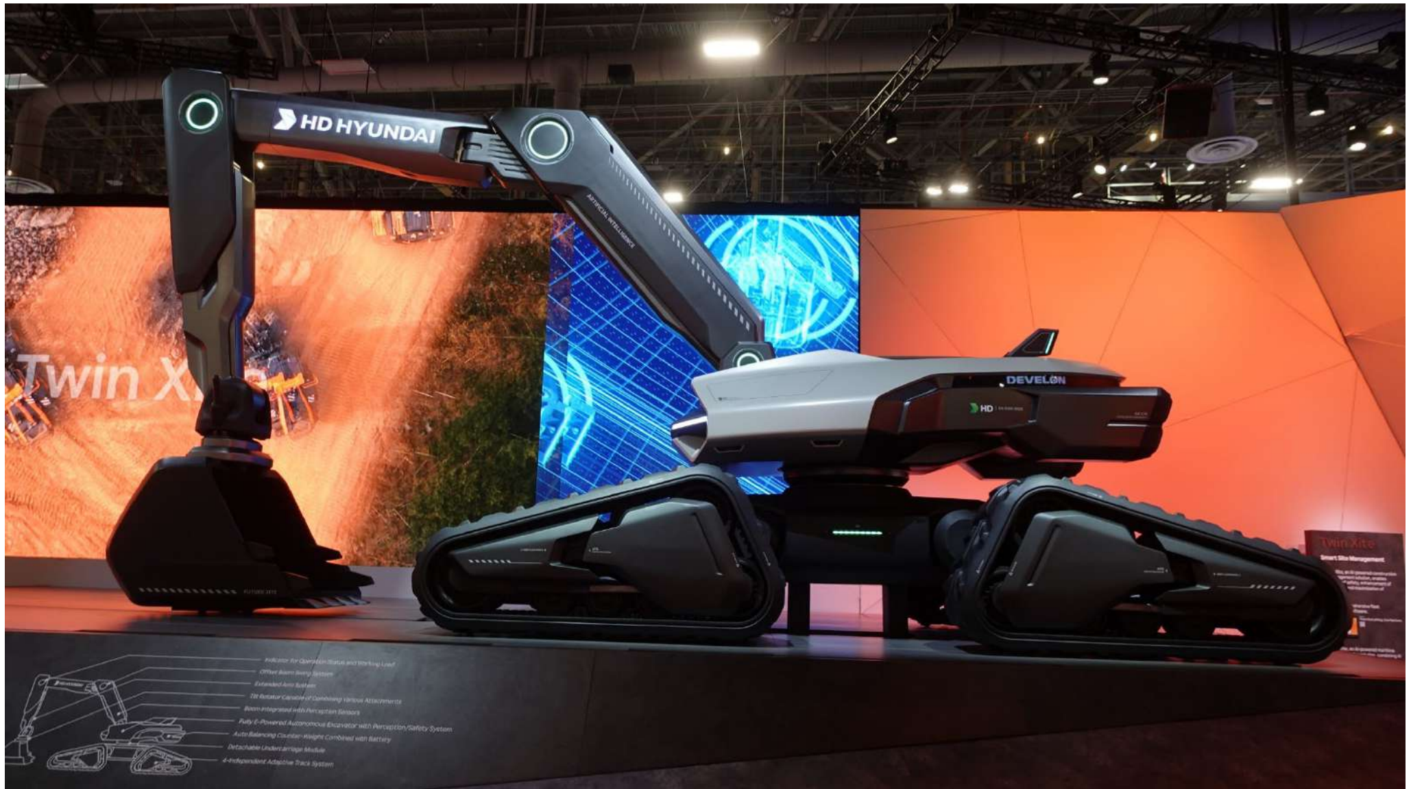
「DEVERON」電動自動運転建機。4輪独立制御され旋回が可能
