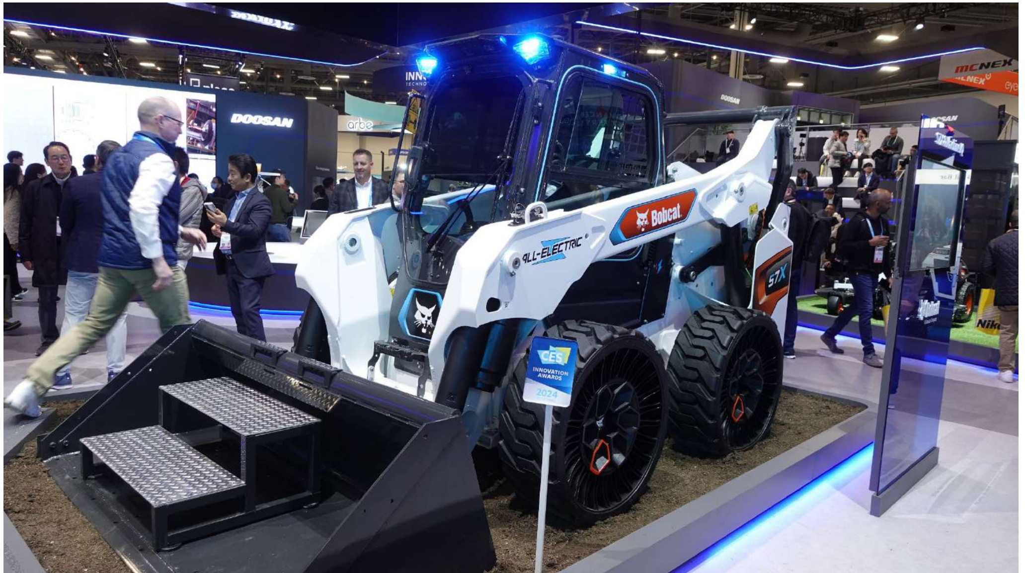
電動のスキッドステアローダー。左右のタイヤの回転差で旋回する
