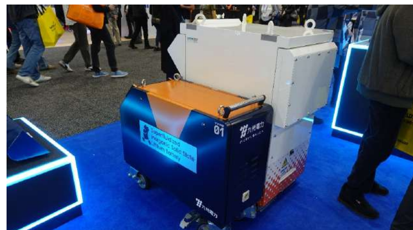
プロロジウムの全個体電池。九州電力が北九州でモジュールを作り可搬型充電器用電源として展示。寿命は3,000回
