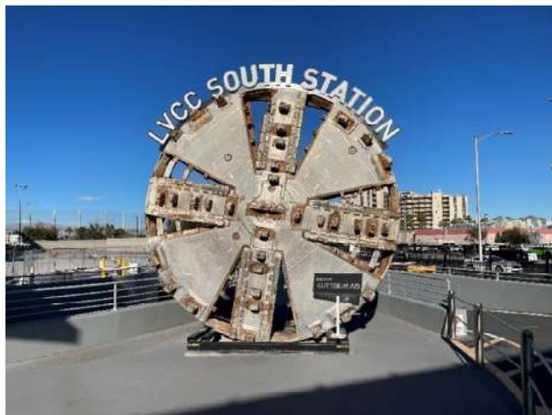
トンネル掘削のカッター
