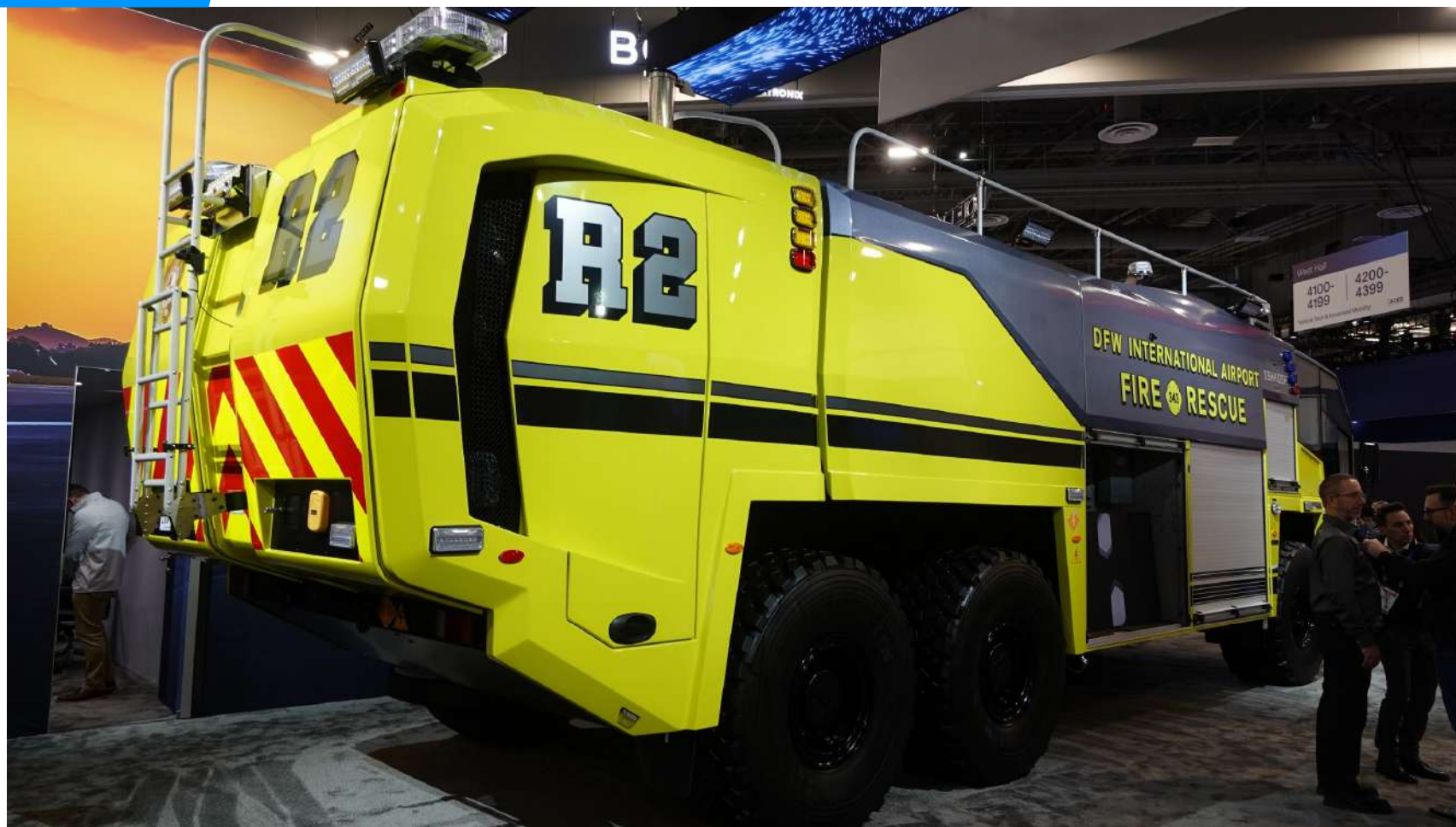
Striker Volterraは空港に配備されるディーゼル&電動モーターのハイブリッド消防車。総重量45トン
