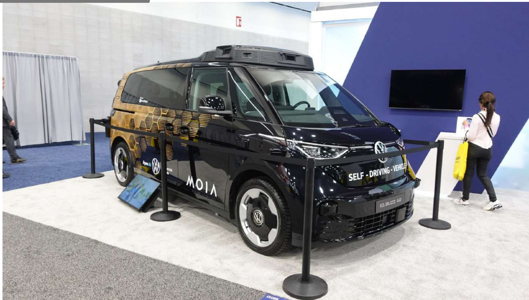
VW ID.BUZZがベースの自動運転。システムはモービルアイ、オペレーティングシステムは、Apex.AI
