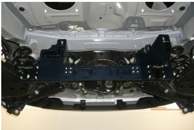
車体下バッテリー搭載改造
