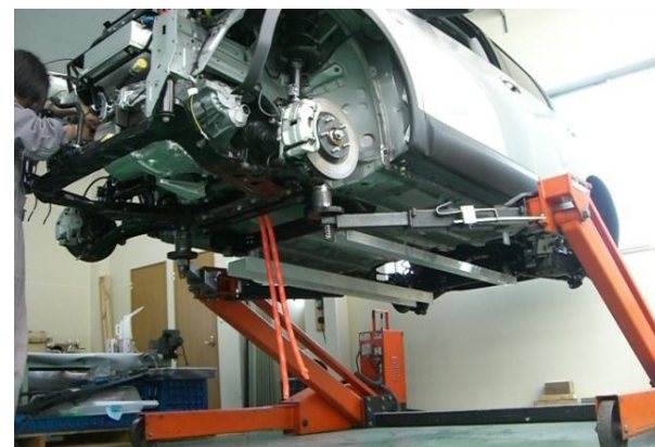
バッテリーベイ取付作業
