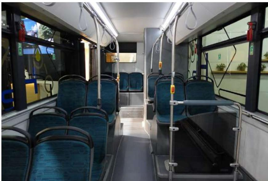
12mクラスの「KENT C HYDROGEN」を出展。VOITHの410kWのモーターに38kg（タンク5本）に140kWhのバッテリーを搭載。定員は82人。
