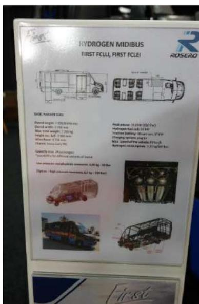
「HYDROGEN MINIBUS」を出展。今回のFCEVバスで唯一の小型FCEVバス。ボンネットを持つため全長は8mクラス。160kWのモーターに37kWhのバッテリーを搭載する。45kWのFCスタックに、35MPaで9.2kg(2本)と2.3MPaの1.66(2本)の水素タンクを搭載する。定員は29人で車両総重量は7,200kg。ベースとなるのはIVECOのDaily。
