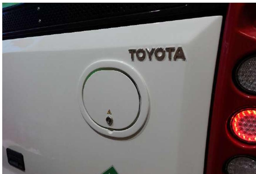
「H2.City Gold」は、右ハンドルの11.7mと左ハンドルの12mの2種類のボディを用意。右ハンドルは主にイギリス向け。180kWのSiemensのモーターに44～80kWhのバッテリーを搭載し、トヨタ製の60kW又は70kWのFCシステムを搭載。5本のType-4の35MPaのタンクに37.5kgの水素でおよそ600kmの航続距離。リアにはTOYOTAのエンブレムが付いていた。
