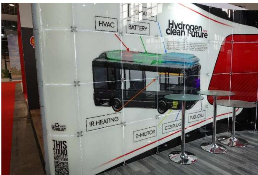
RampiniはEVバスの「ELTRON」のFCEV版「HYDRON」を出展。8mで最大48人乗り。230kWのモーターに174kWhのバッテリーを搭載し、35MPaの水素容量3.6kg×3本のタンク(合計10.8kg)で400kmの航続距離を持つ。CCS2で充電できるプラグイン式FCEVである。他にも路線EVバス2台も出展。
