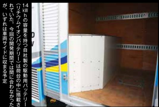
14kWhの容量を持つ自社製の駆動用バッテリー(チフクイオンバッテリー)は荷台の中に搭載されていた。今回の開発期間では間に合わなかったが、いずれは車両サイドに収まる予定
