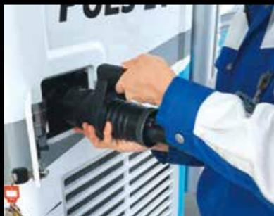
燃料の水素は、FCユニット左の充填口に水素ステーションなどのコンプレッサーで圧縮した高圧水素を充填。FC小型トラックの充填時間は約3分半ほどで、一般的な小型トラックの給油時間とさほど変わらない
