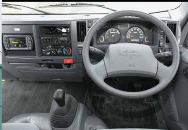
キャブ内のパッと見は市販のエフルと変わらないが、回転計はモーターの回転数となっているほか、排気ブレーキレバーの操作は回生ブレーキの強弱に置き換わっている
