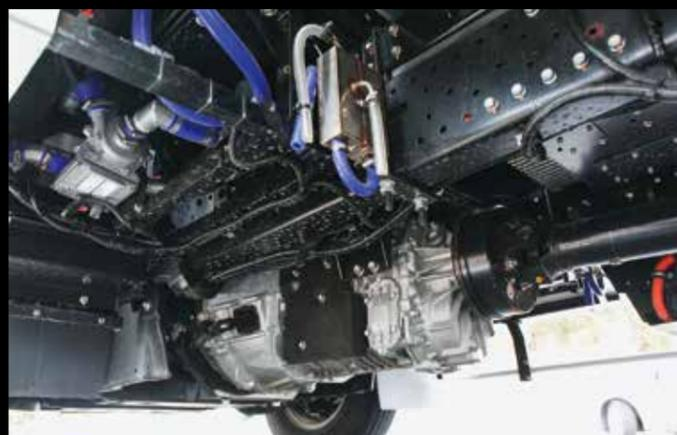
モーターからの動力は市販車の6速のマニユアルトランスミッションとプロペラシャフトを介し駆動。これによりコストダウンだけでなく、最高時速105km/h、登坂性能20%以上を実現している。サイドフレーム横の四角い金属とホースのパーツは燃料電池から出る水の排出口だ
