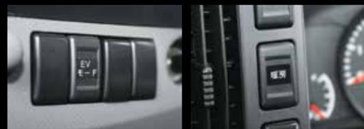
FCスタックの発電を止めて走行できるEVモードスイッチや、過度な暖房の使用を抑えるため、暖房のオンオフを行なうヒータースイッチも追加している
