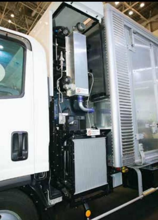
荷台とキャブの間に収まるFC小型トラックのFCユニット。ユニット上部には最高充填圧力70MPaの36ℓ高圧水素タンクを3本(計108ℓ)、下部には33kWの発電量のFCスタックを2基(計66kW)、FCスタック用のラジエーター2基を搭載する。同車は、70MPaで水素を満タンにした場合、JC08モード燃費で約150kmの航続距離を実現している
