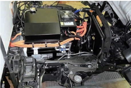
インバータ・コンバータ inverter and converter
