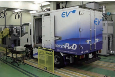
JC08シャシダイナモメータテスト JC08 chassis dynamometer test
