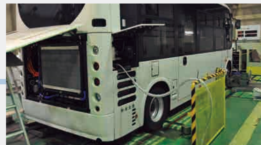
シャシダイナモメータ試験 Chassis Dynamometer Test
