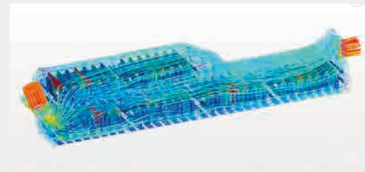
バッテリーパック熱流体解析 (流れ、放熱性評価) Battery pack thermal fluid analysis (Flow, heat dissipation evaluation)
