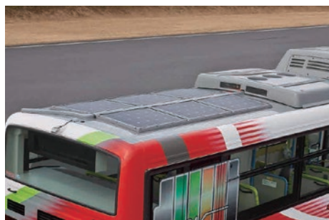
ソーラーパネル Solar PV panels
