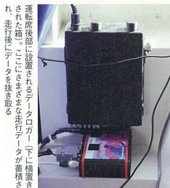
運転席後部に設置されるデータロガー(下に横書きされた箱)。ここにさまざまな走行データが蓄積され、走行後にデータを抜き取る
