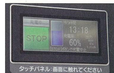
急速充電器のコントロールパネルはタッチパネル方式を採用。モニターには車両側のバッテリー残量と満充電(80%)までの時間経過が表示される
