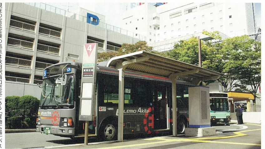
停留所で急速充電中のELEMO-AKITA。1行程を終えるごとに充電する運用方法が採られており、約10分で満充電(80%)状態にすることができる
