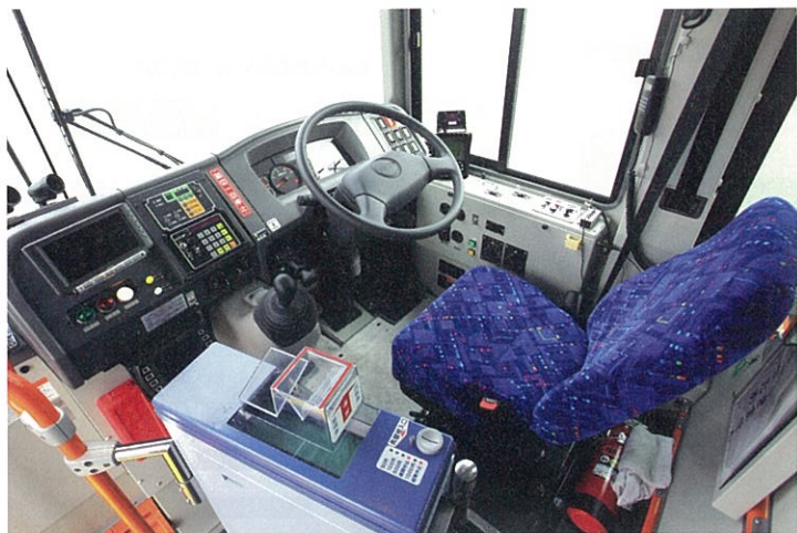
運転席はベース車両からほとんど変化はない。マニュアルトランスミッションもそのまま流用され、運転操作もエンジンバスと大きな違いはない
