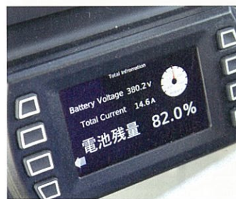
運転席左手に設置されている走行用バッテリーの充・放電状況を表示するモニター。左/通常走行の状態、Total Currentのアンペア数がアクセル開度やモーター負荷に比例して大きくなる。右/下り坂で回生ブレーキを使用中の状態で、Total Currentがマイナス表示になっていることが確認できる
