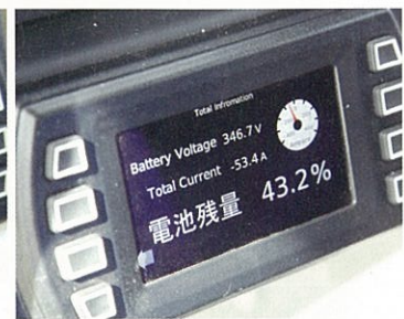
運転席右手にもモニターが設置され、走行用バッテリーの残量、電圧、温度などがリアルタイムで表示される
