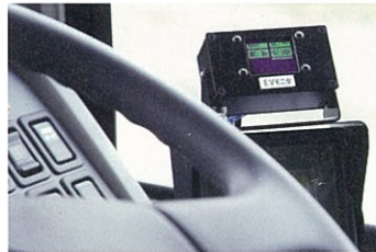
運転席右手にもモニターが設置され、走行用バッテリーの残量、電圧、温度などがリアルタイムで表示される
