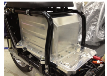
図13 ピューズ製電池パック仕様1 車両搭載例
