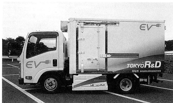
いすゞエルフの使用過程車をキット改造した東京R&DのEV。サイドのバッテリーケースが目立つほかは、見た目はディーゼル車と変わらない
