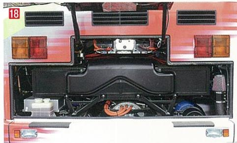
震災で運休しているJR気仙沼線の仮復旧措置であるBRTに、4月17日から電気バス「e-BRT」が加わった。中型車のいすゞエルガミオノンステップ（LR290J1）をベースに、東京R&Dが電気バス化。トランスミッションやクラッチを残すとともに150kWモーターを採用し、後部とルーフ上に三菱重工製リチウムイオンバッテリー（計65.12kWh）を搭載。さらに車内照明などの電源用としてルーフに太陽光パネルを設置している。車内はノンステップバス郊外型を基本にしなが、車内照明にはLED式スポットライトと同ファイバーライトを採用。さらにグリーン系の内装色に青系のスタンションポール／降車合図ボタンを組み合わせるなど、新規性や独自性を打ち出している。さらに一部シートの背面にモバイル機器充電用のUSBコンセントを設置し、サービス性も高めている。運行はミヤコバスが担当し、本吉―気仙沼間（片道22km）を1日2往復、片道走行ごとに急速充電される
